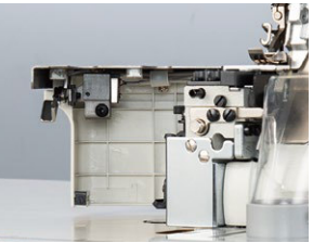
2. Nắp tấm may với công tắc điện từ đóng/ mở
