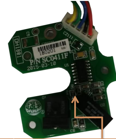
Bộ mã hóa động cơ vòng khép kín
